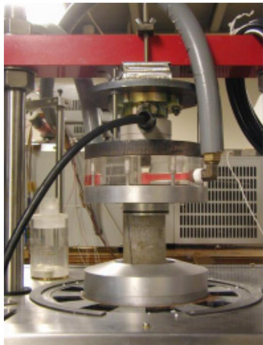
写真-2 凍上力計測時
