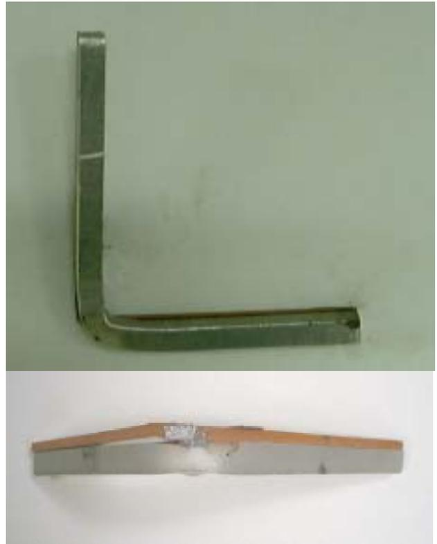
図7 曲げ試験結果
