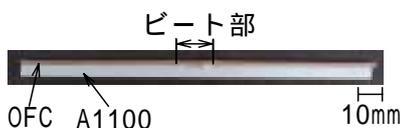
図 6 試験片断面の外観写真
