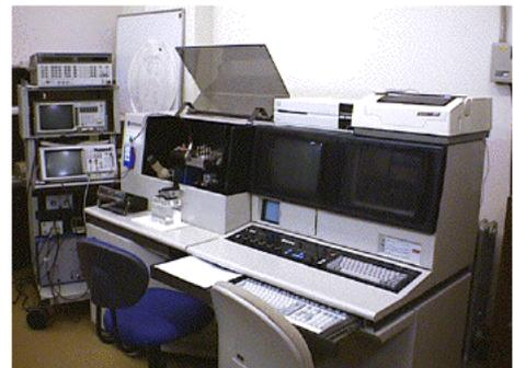
図1 超音波顕微鏡
