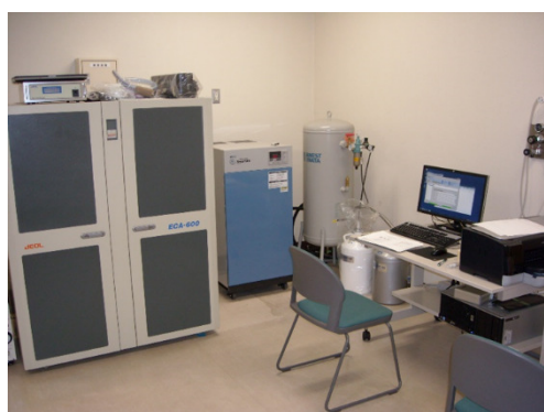
図 7 分光計コンソール、エアコンプレッサー、データシステム
