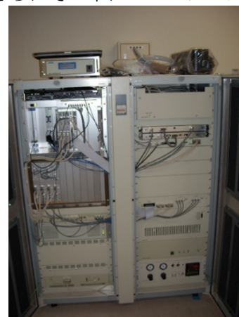
図 8 分光計コンソール内部
