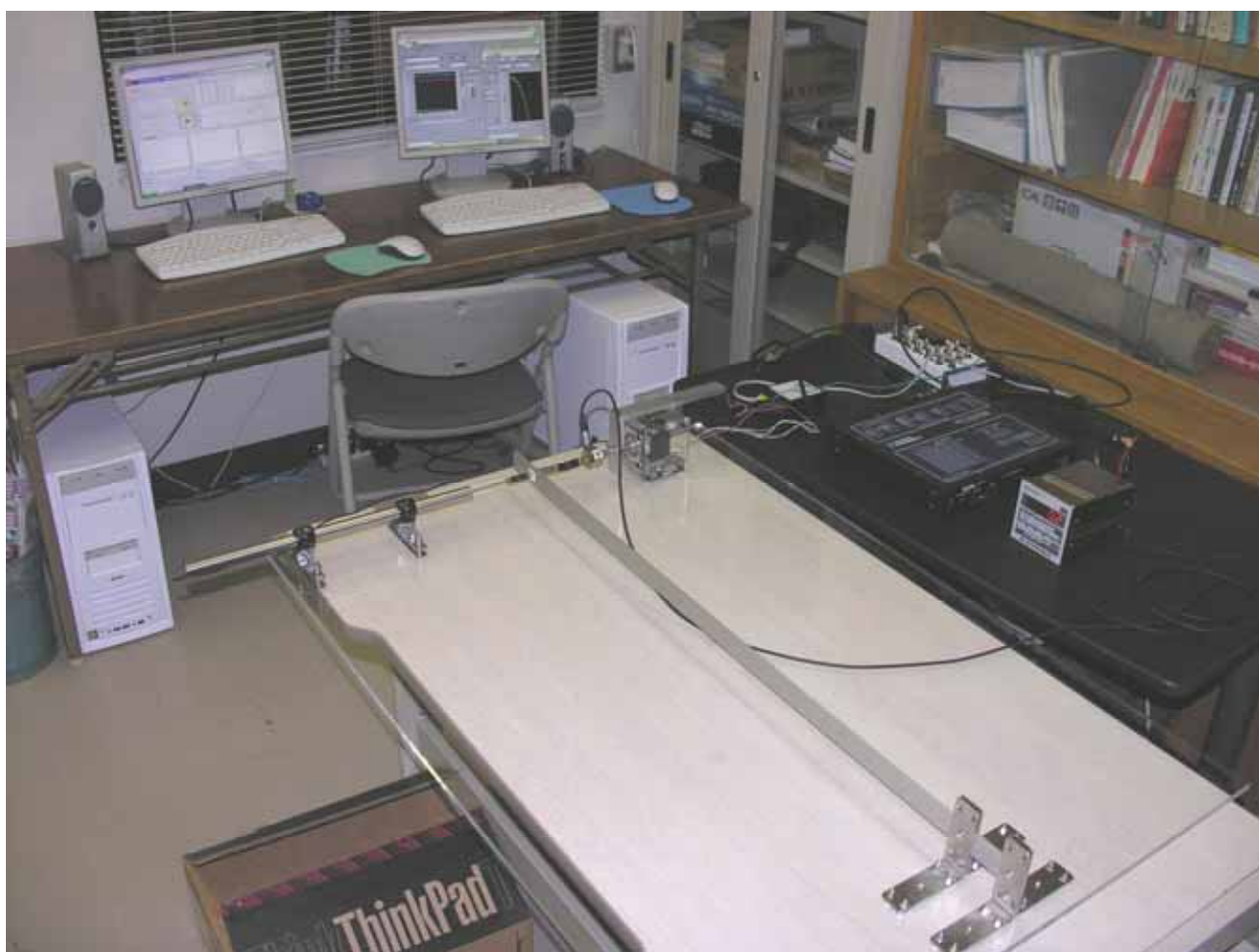
図3 サブストラクチャ仮動的実験の外観図
