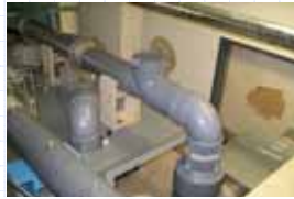
写真2 流速分布測定用換気装置
