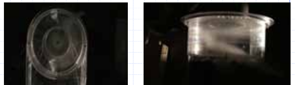
画像1 軸流式サイクロン集塵機可視化画像
