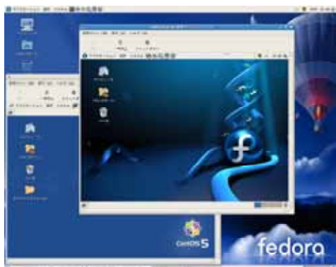
図1 Xen上でCentOS5/Fedora Core6を動作させた
