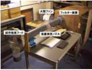
写真1 集塵測定用換気装置
