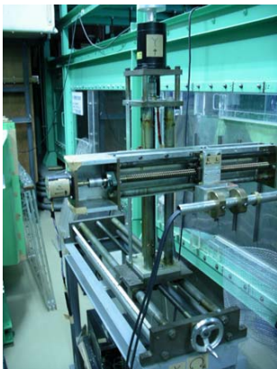
写真1. 3軸トラバース装置 (2軸自動制御)
