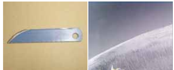
(a) 全体図 (b) 刃先の仕上げ面状態
