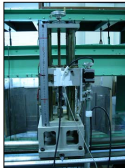
写真5. 風洞内用トラバース移動トラバース装置
